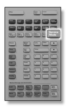
[Service Mode] Используется для доступа к функциям и параметрам обслуживания, служебным счетчикам и средствам диагностики ГХ.
