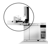
Установите пробоотборник и лоток и подсоедините кабели к задней панели.
