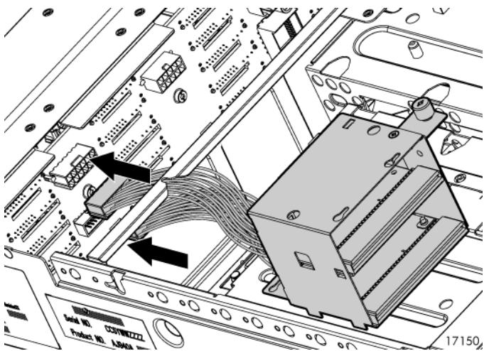
2. Задвиньте и опустите модуль регулятора напряжения на место (1), закрутите винт (возможно, потребуется ключ T-15), чтобы зафиксировать модуль (2).
