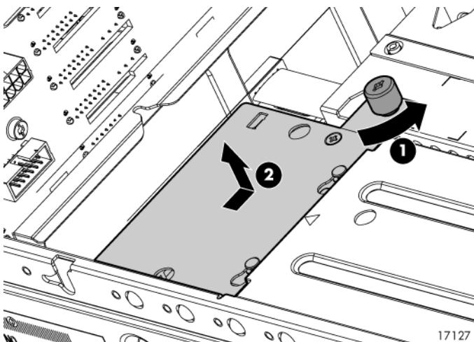
11. Поднимите и извлеките модуль регулятора напряжения вместе с кабелями из корпуса массива.
